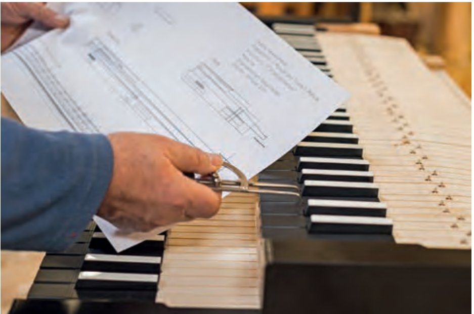
Die Pedalklavatur (oben) und die Feinjustierung der beiden Manusklavaturen.
