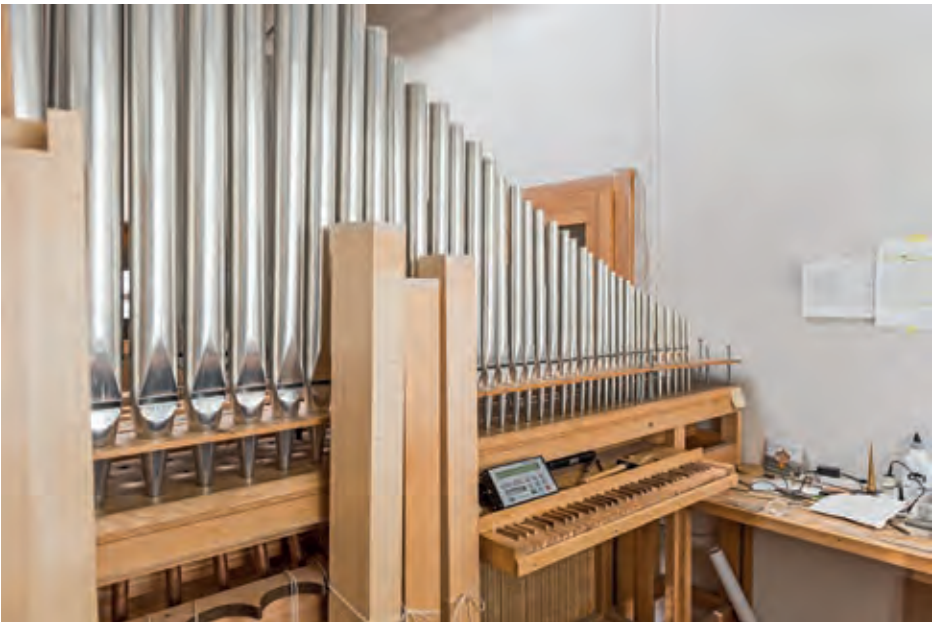
Das Zungenregister Oboe 8' (oben) und die Stimmung der Prinzipalpfeifen – die endgültige Intonation erfolgte im Gewandhaus zu Leipzig.
